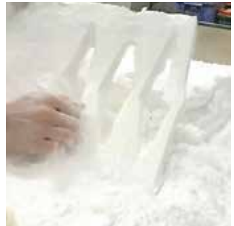
Auspacken der Leuchte aus dem Pulver.
